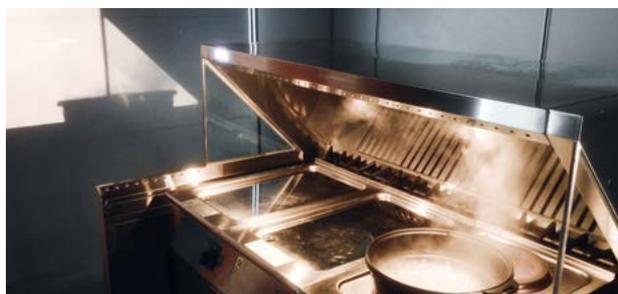
Ein Shadowgraph zeigt an einem Bildschirm die von einem Kochgerät freigesetzte Wärme.
