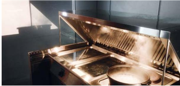
Un « shadow graph » permet de visualiser la chaleur dégagée par un équipement sur un écran aligné avec la zone testée.
