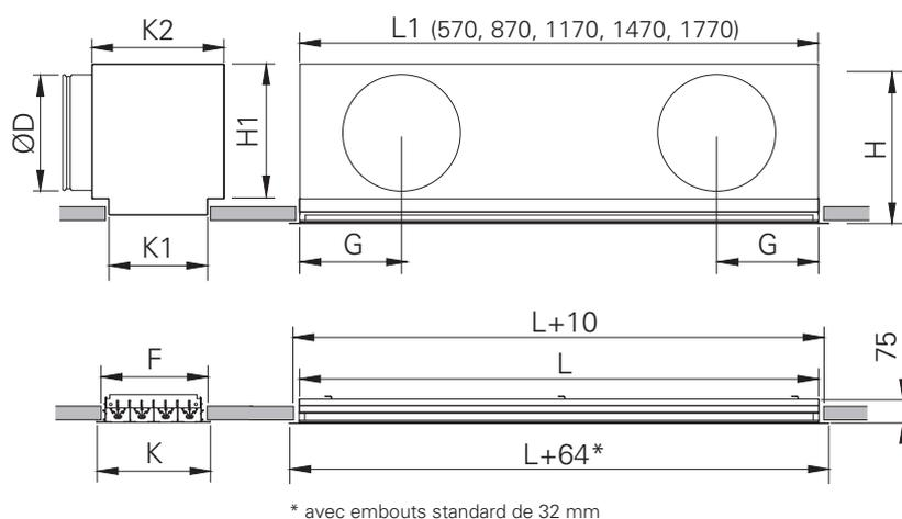
Les dimensions standard de l'ensemble plénum + diffuseur sont données dans le tableau ci-dessus (dimensions H).
