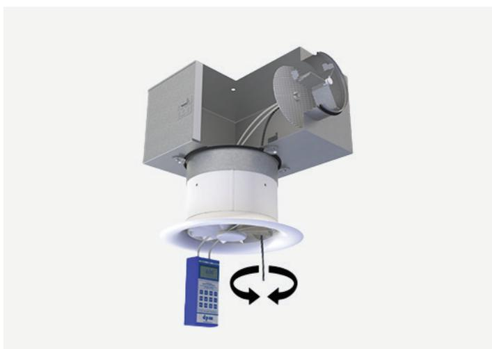
Régler le débit en tournant la tige de commande du MSM jusqu'à l'obtention de la valeur désirée. Remettre les tubes et la tige de commande en place dans le caisson.
