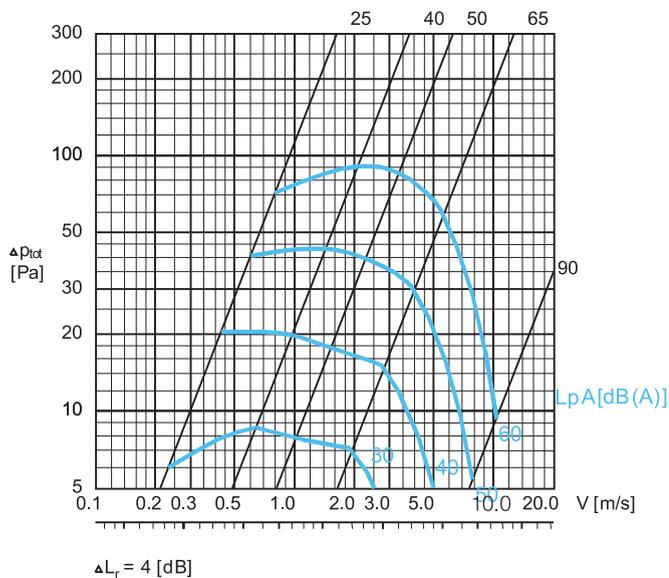
Le niveau de puissance acoustique  $L_w$  dans chaque bande d'octave est calculé en additionnant le facteur de correction  $K_{ok}$  et le niveau de pression acoustique issu du tableau de sélection, selon la formule suivante :
