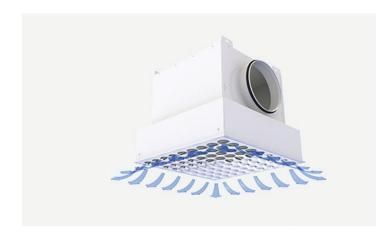
L'air est filtré au passage de la cellule à filtre absolu. Les buses réglables permettent l'orientation de la veine d'air. Les buses peuvent être réglées par intervalle de 15°.
