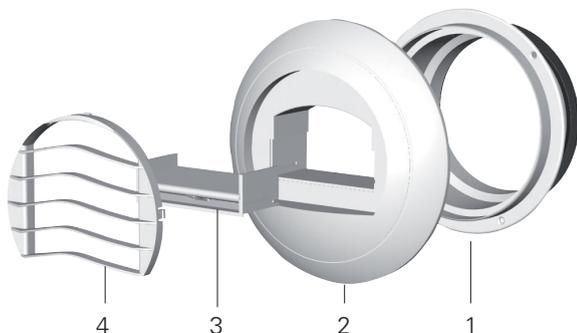
Oter la grille (4) et le module de régulation (3) du corps de la bouche (2). La manchette (1) ne doit pas être déposée du conduit.
