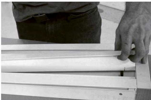
3. Retirer les profilés en T pour pouvoir accéder aux orifices de montage des barres transversales.
