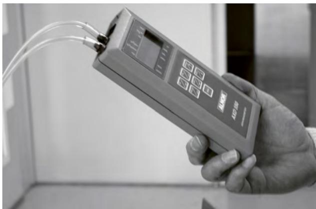
9. Mesurer la différence de pression à l'aide d'un manomètre différentiel. Après lecture de la pression différentielle ( $\Delta P$ ) sur le manomètre (en Pa), il est aisé de déterminer le débit soufflé en utilisant la formule suivante :
