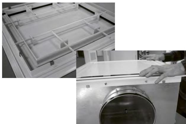
2. Pour des diffuseurs de dimensions 600x600, le diffuseur est fixé au plénum au moyen de clips. NB : Pour des diffuseurs 675x675, le diffuseur est fixé au plénum au moyen de vis ou de rivets pop (non fournis).
