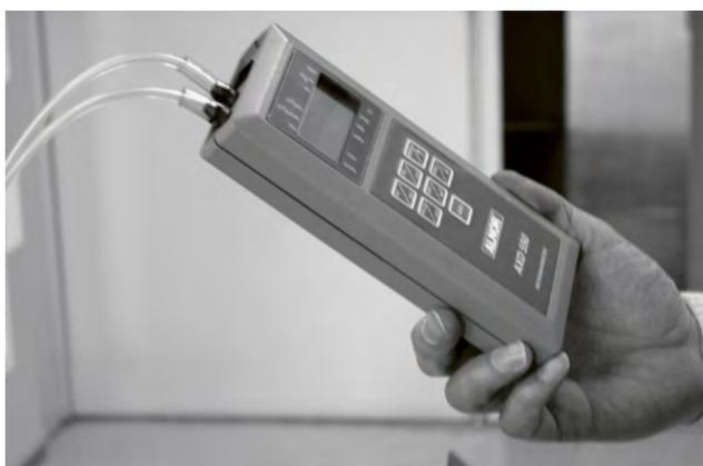
9. Mesurer la différence de pression avec un manomètre différentiel. Après lecture de la pression différentielle ( $\Delta P_m$ ) sur le manomètre (en Pa), il est aisé de déterminer le débit soufflé en utilisant la formule suivante :
