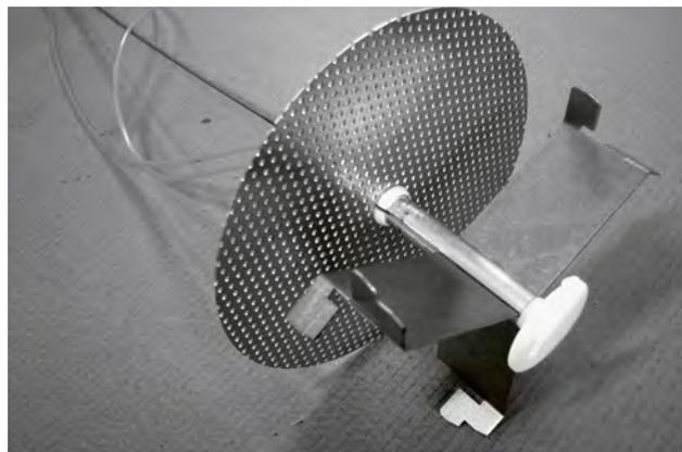
8. Appareil de mesure et de réglage (en option). La différence de pression est mesurée à l'intérieur du plénum, ce qui permet de régler le débit soufflé.
